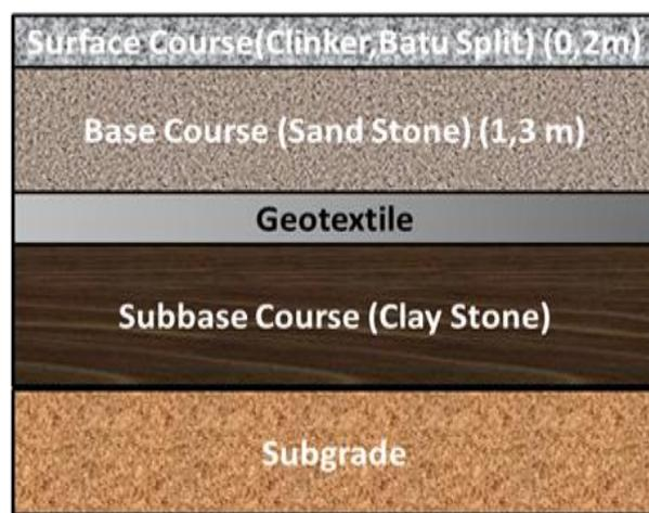
Gambar 5. Desain pemasangan *geotextile*
