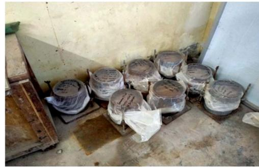
Gambar 3. Proses pemeraman benda uji
