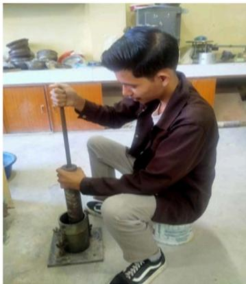
Gambar 8. Proses uji *standard proctor*
