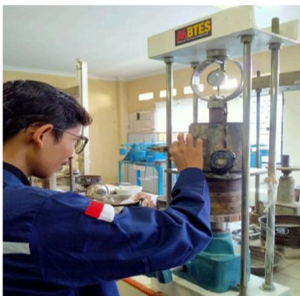
Gambar 9. Proses pengujian CBR tanah
